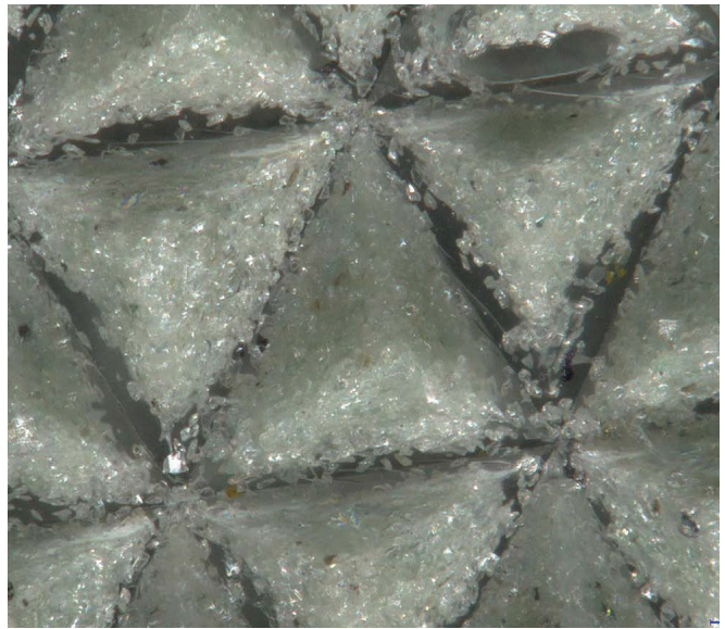
Vue microscopique du grain des disques de dégagement adhésifs MICROFINISH.
