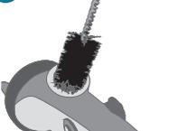
Nettoyez le raccord produit à l'aide d'une soufflette et d'un goupillon
