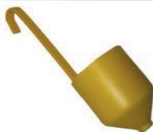
Permet de mesurer la viscosité des peintures liquides. Remplir entièrement la coupe, puis mesurer le temps d'écoulement du liquide.
